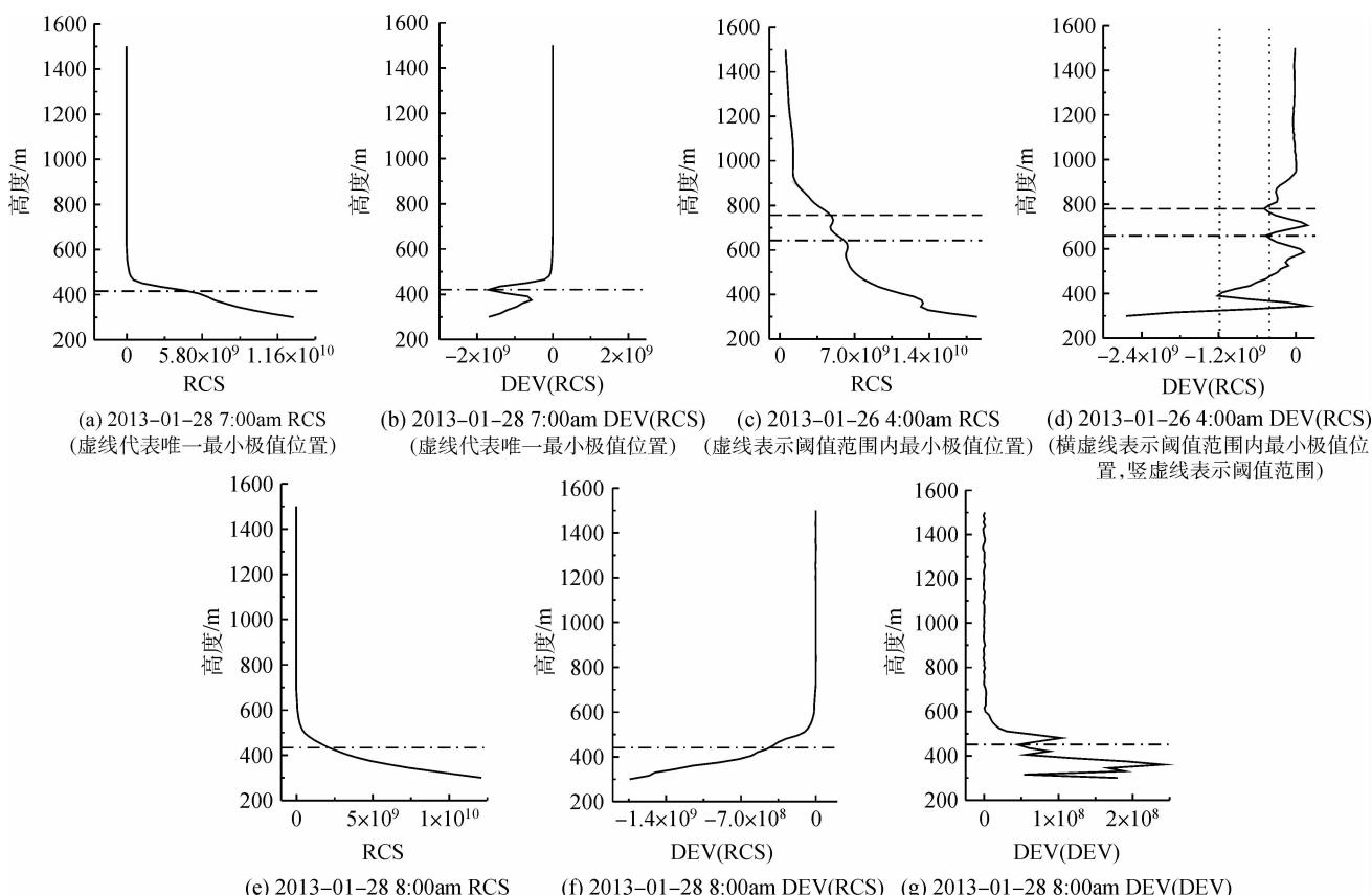
图2 激光雷达探测大气边界层高度判读结果
