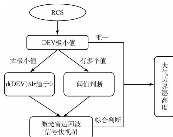
图1 激光雷达探测大气边界层高度判读流程图
