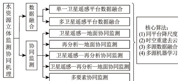
图1 协同地面站点、卫星遥感、再分析数据的水资源立体监测协同机理框架图
