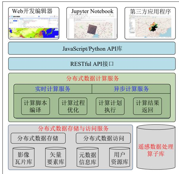
图1 PIE-Engine Studio 遥感云计算平台系统架构
